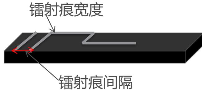
尽管更窄及更小间隔的镭射痕可能实现，但在实际应用中已经证明 $\geq 150$ 微米的镭射痕宽度及 $\geq 200$ 微米的间隔是最理想的
